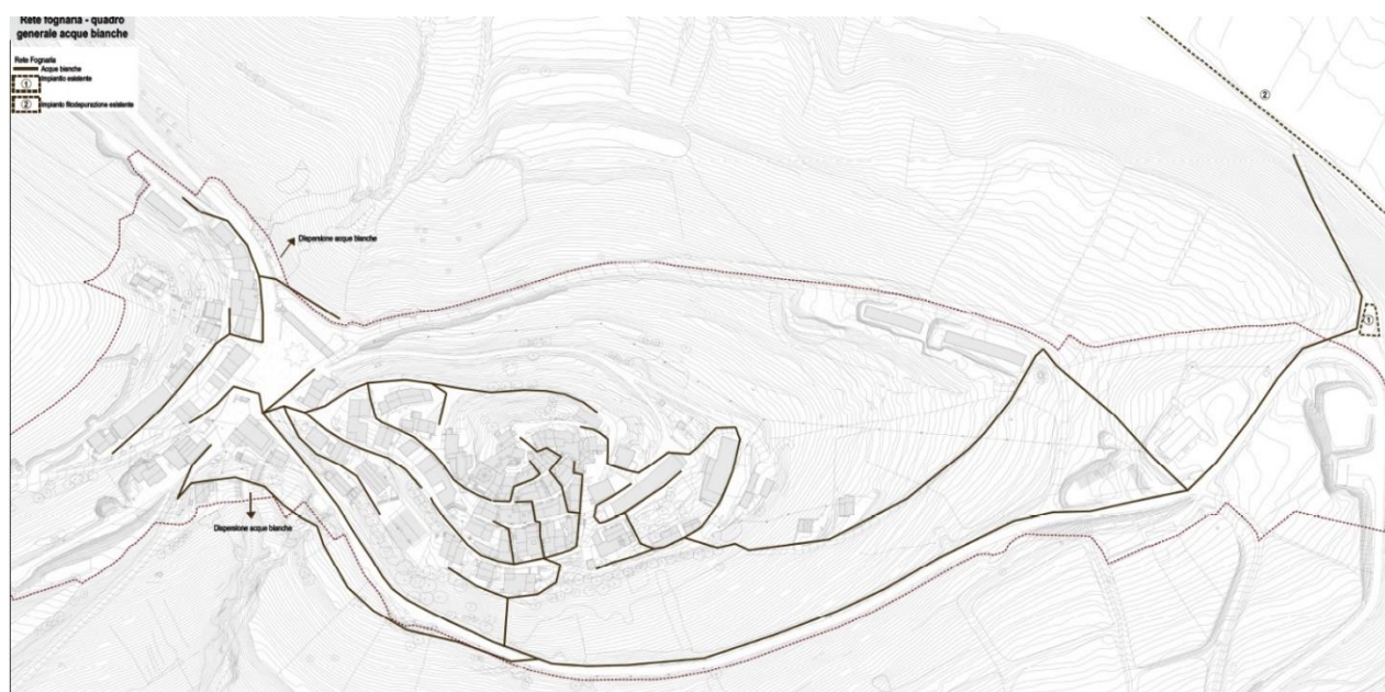
Planimetria del sottosistema fognario
